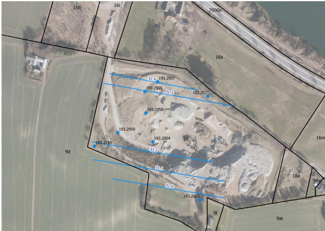
Figur 6.7 Grundvandspotentialer for terrænnært grundvandsmagasin ved Bregnebjerggård Grusgrav.
